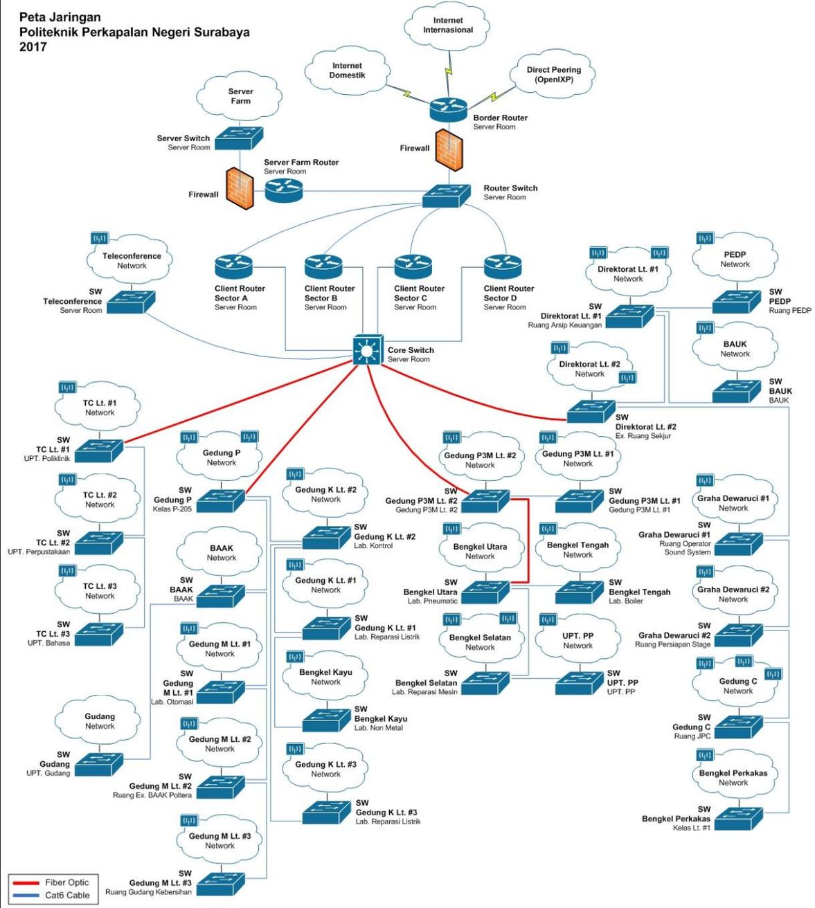
PPNS saat ini sudah mempunyai 32 titik akses nirkabel (wireless access point) untuk menunjang distribusi internet di seluruh area PPNS. Perbaikan berkelanjutan terus dilakukan, diantaranya penambahan server , storage, firewall switch dan access point untuk meningkatkan distribusi internet di area PPNS.
